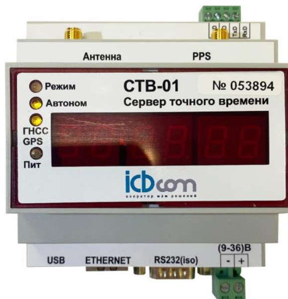
Рисунок 2.2. Передняя панель блока управления СТВ-01 (DIN)
